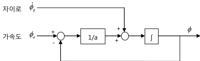
블록 다이어그램을 살펴보면, 가속도 센서로부터 측정한 각도( $\phi_a$ )는 센서의 적분 각도( $\phi$ )와의 차를 이득  $1/a$ 를 곱하여  $\phi$ 에 적분한다. 그리고 차이로 센서로부터 측정한 각속도( $\dot{\phi}_g$ )는  $\phi$ 에 그대로 적분한다. 여기서 주의할 점은,  $\dot{\phi}_g$ 는 센서 좌표계를 기준으로 하는 각속도 값이고,  $\phi_a$ 는 전역 좌표계를 기준으로 하는 각도 값이라는 점이다. 이 때문에 적분하는 방법에 차이가 있다.
