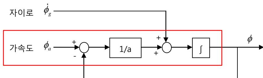
중력가속도는 항상 지구 중심으로 향하기 때문에 가속도 센서에 다른 힘이 작용하지 않을 경우  $\mathbf{g} = (0, 0, -9.81)$  가 측정된다. 가속도 센서에서 측정한 가속도와 중력가속도를 비교함으로  $\mathbf{R}$  를 보정할 수 있다. 하지만 이러한 조건은 가속도 센서에 작용하는 힘이 오직 중력만 있을 때 가능하다. 중력가속도와 이러한 힘을 분리하여 측정할 수 없기 때문에, 중력가속도 외 다른 힘이 작용하고 있는 조건은  $\|\mathbf{a}\| \approx \|\mathbf{g}\|$  인지 확인해 보는 것이 제일 간단한 방법이다.
